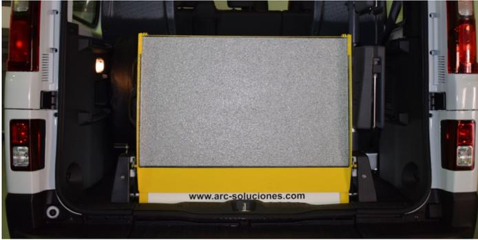
**Rampa manual ligera.** Fabricada en material de fibra sobre un elegante marco de aluminio. Cuenta con una superficie total de 80 x 150 cm, permitiendo el acceso al vehículo desde cualquier tipo de silla. La hoja se divide en dos secciones, garantizando la visibilidad del conductor.
